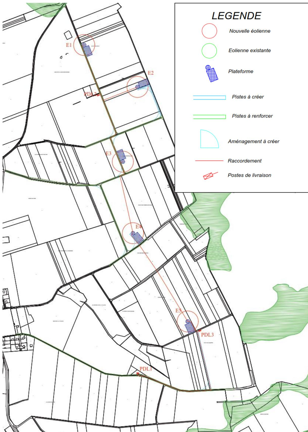
FIGURE 21 : PLAN D'IMPLANTATION DES EOLIENNES AVEC CHEMIN D'ACCES ET POSTES DE LIVRAISON
